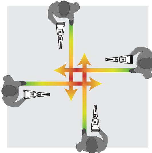
Después de que el punto objetivo esté detectado y ubicado, márkelo y continúe con el proceso de medición de Profundidad.
