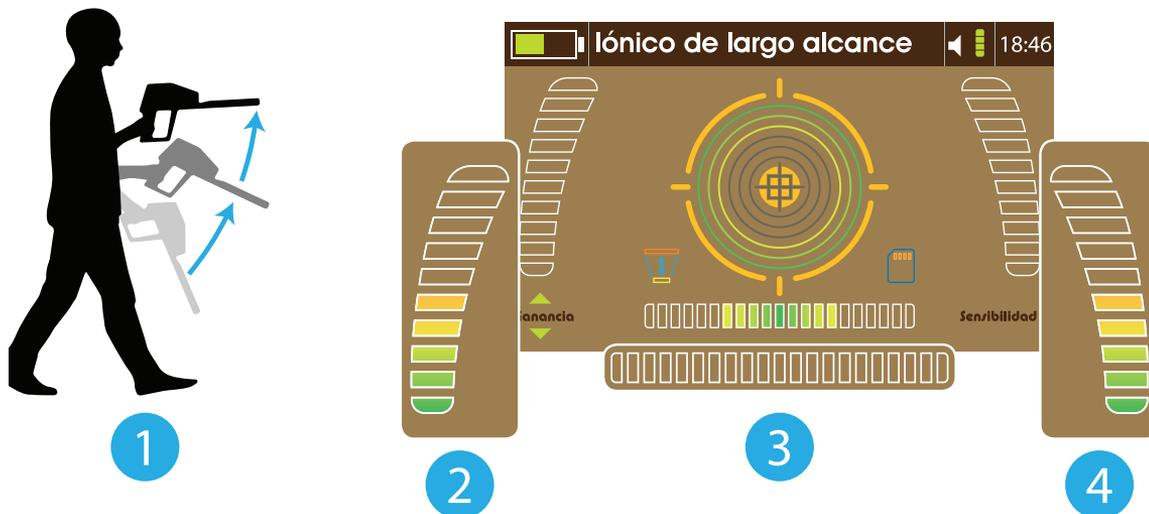
Antes de continuar con la búsqueda el dispositivo debe estar equilibrado con el valor de terreno.
